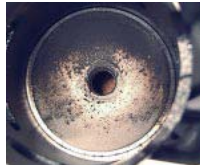
Sämsta cylindern. Mer än en tredjedel av ytan har beläggningar.
