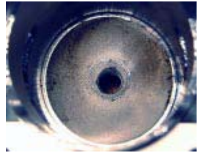
Bästa cylindern. Mindre än en tredjedel av ytan har beläggningar.
