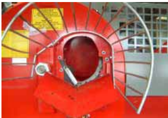
Bild 30: Inmatningsöppningen med de fasta knivarna.
