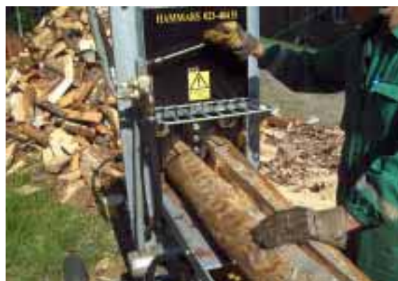
Bild 42: Klyvning och klippning av långved.
