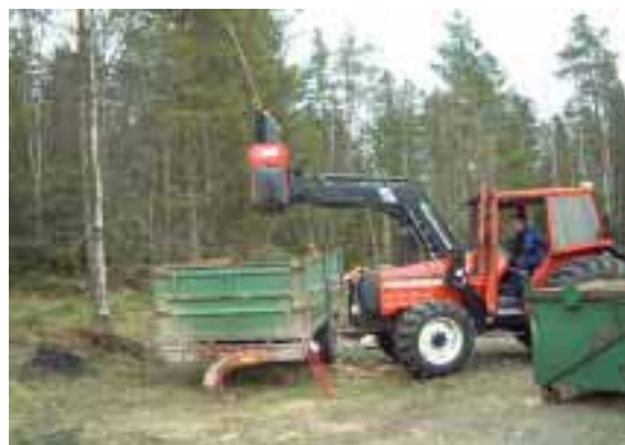
Bild 47: Den färdiga veden kan fås direkt på ett släp.
