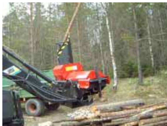
Bild 45: Långveden matas ned i maskinen av sin egen tyngd.
