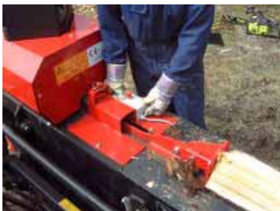
Bild 50: Körning av manuella klyvfunktionen.
