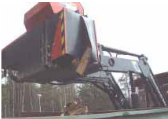
Bild 46: Den färdiga veden kommer ut under maskinen.
