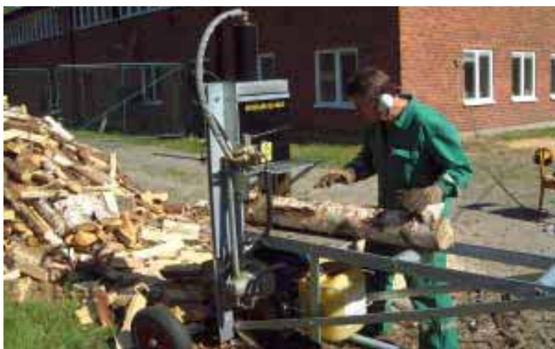
Bild 43: Körning med Hammars vedklipp.
