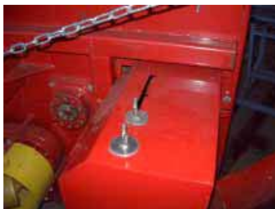
Bild 34: Justering av vedlängdsbegränsare.
