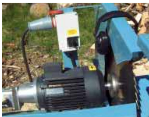
Bild 3: Gemensam elmotor för drivning av pump och kapklinga
