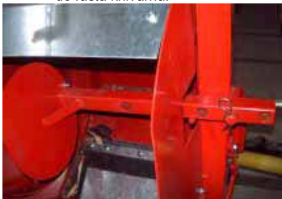
Bild 32: Inställning av vedlängdsbegränsaren.
