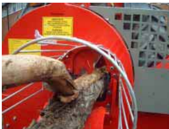
Bild 29: Klippning och klyvning i samma rörelse med Klappi.
