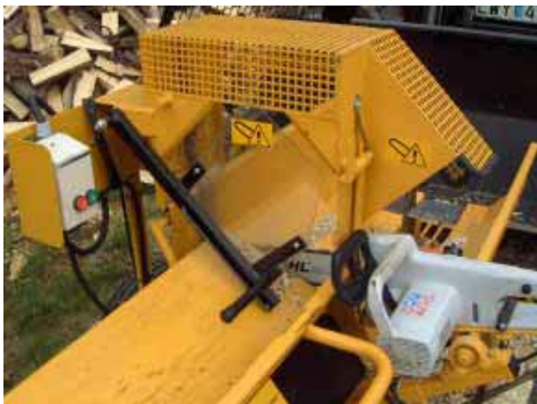
Bild 26: Stockhållare och skydd vid inmatning.
