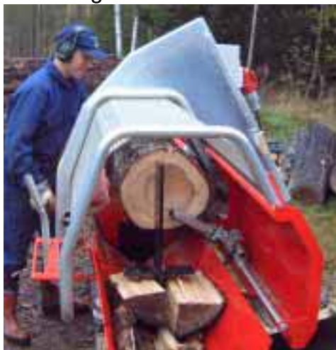
Bild 11: Inmatning av långved mot Vedlängdsbegränsare.
