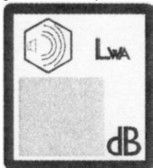
Bild 1. Garanterad ljudeffektnivå i dB anges enligt bullerdirektivet med denna symbol på maskinen.
