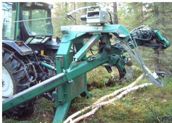
Bild 6: NIAB med utskjutet gripaggregat
