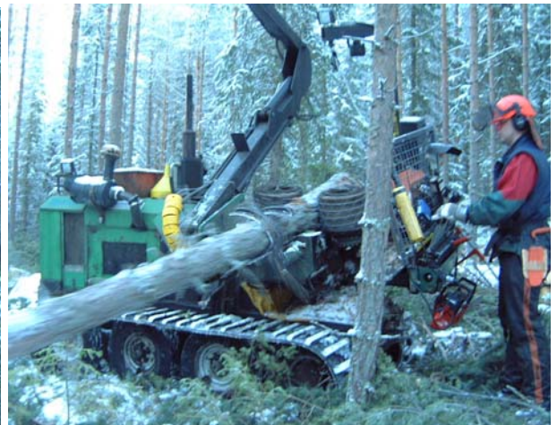
Bild 18: Inmatning och kvistning av träd.
