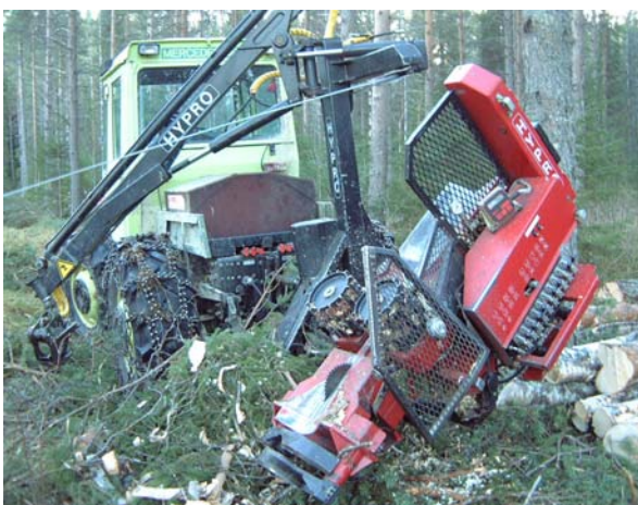
Bild 11: Hypro 450 XL i position för vinschning Bild 12: Iläggning av träd med kranen.
