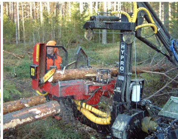
Bild 16: Körning med processorn, kapning.
