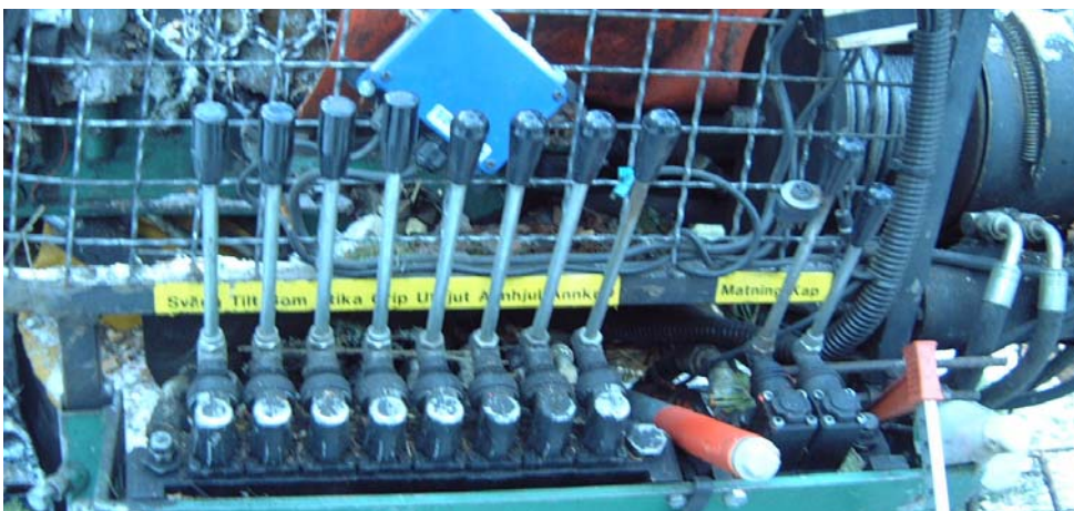
Bild 21: Manöverreglagen, placerade baktill på maskinen.
