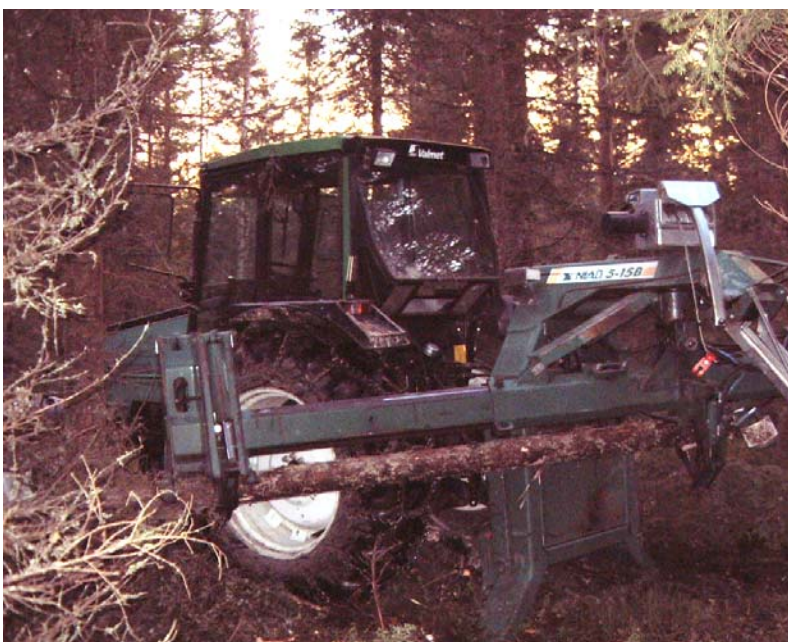
Bild 10: Principen för kvistning på NIAB
