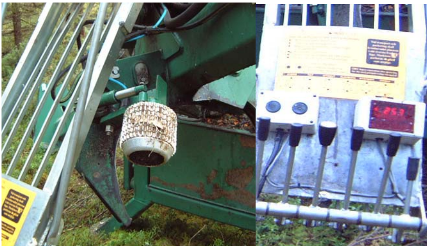
Bild 9: Längdmätningstrustning på NIAB
