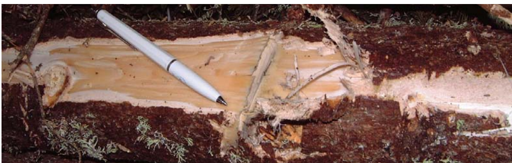
Bild 7. Skador på virket efter upparbetning med NIAB processor.
