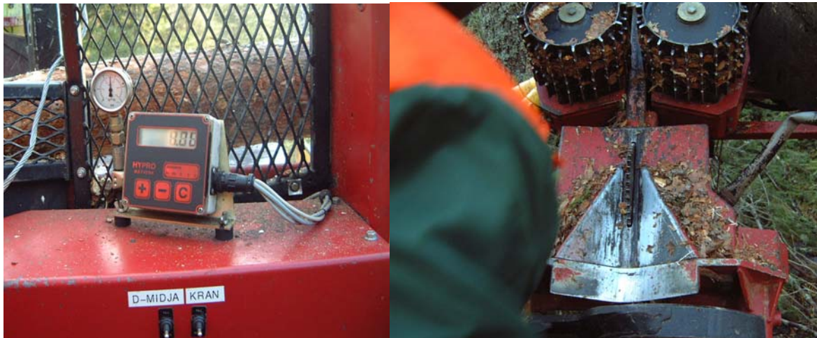
Bild 14: Längdmätutrustning monterad på Hypro 450 XL
