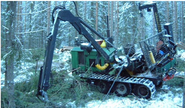
Bild 22: Kranen som extra stöd mot stjälpning vid vinschning
